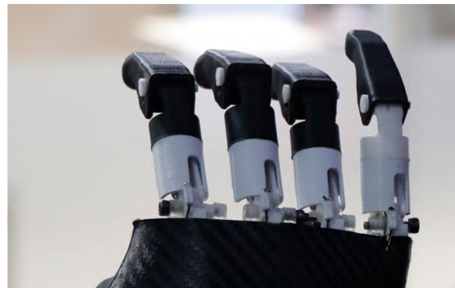
Prótesis robótica de mano para personas con desarticulación de la muñeca, CUCEI
